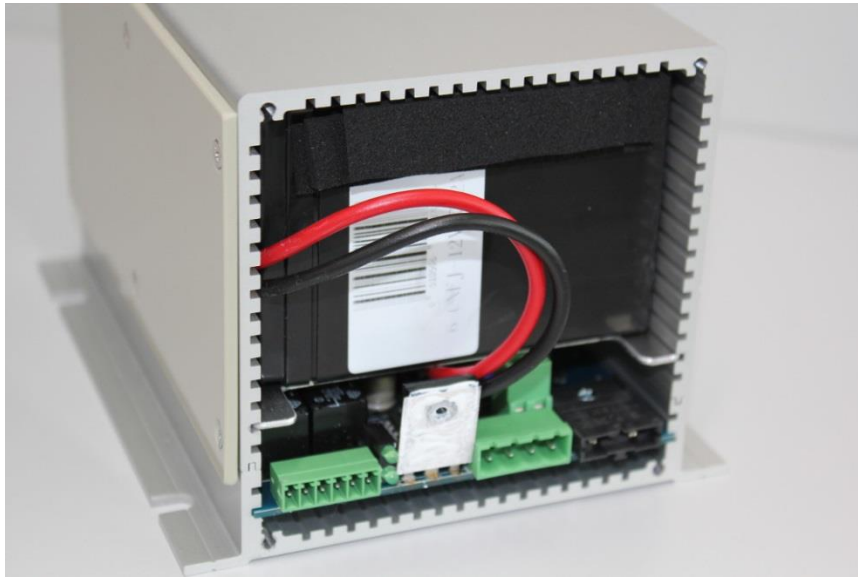
Abbildung 2 - IRA-USV 12V interner Aufbau
