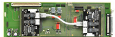
Anschluss von dSPACE-Echtzeitsystemen an EtherCAT-Netze als Slaves (Quelle: dSpace)
