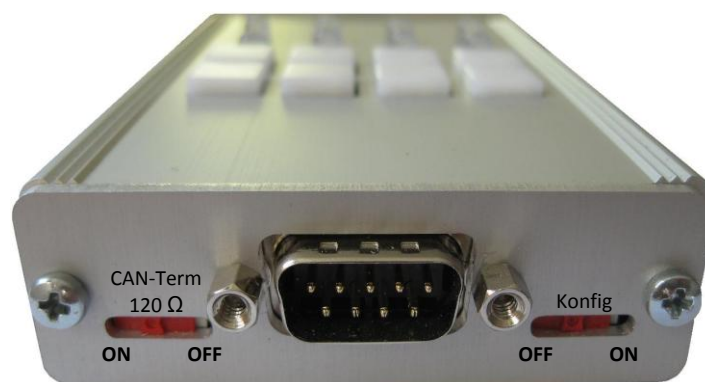
Abbildung 3-2: Unterseite der Fernbedienung (SUB-D9, 2x DIP-Schalter)
