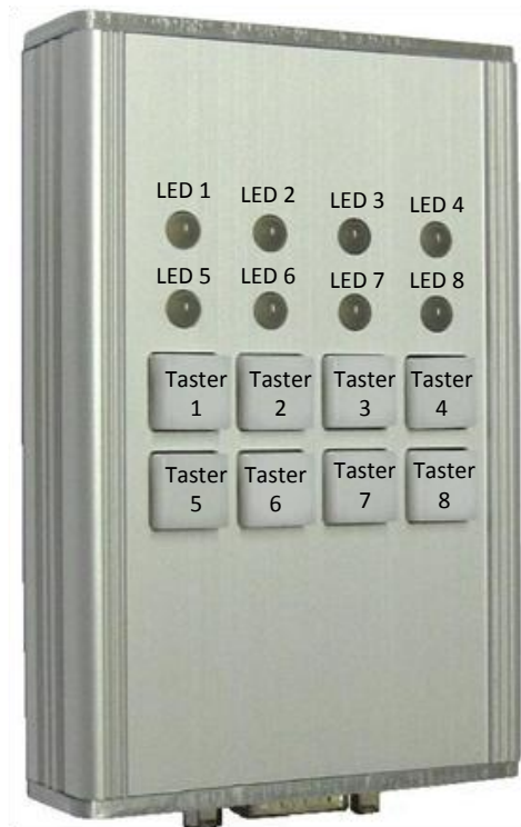
Abbildung 3-1: Nummerierung der LEDs und Taster
